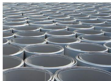
За счет встроенной линии по производству кожухов MABI Bingo 2 EVO вальцует до 6 готовых к монтажу кожухов в минуту.
