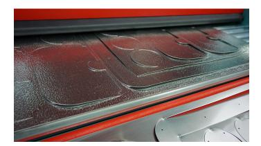
Taglio direttamente dal coil / nastro. Scarto minimizzato, incluso programma (nesting) per uno sfruttamento, ottimale della lamiera. Risparmiate con la lamiera, ma non con il macchinario.
