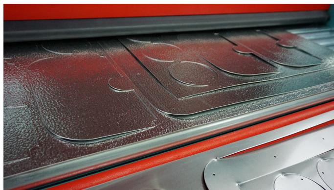
Découpe directement à partir de la bobine : pratiquement pas de chutes. La tôle est donc utilisée au maximum.
